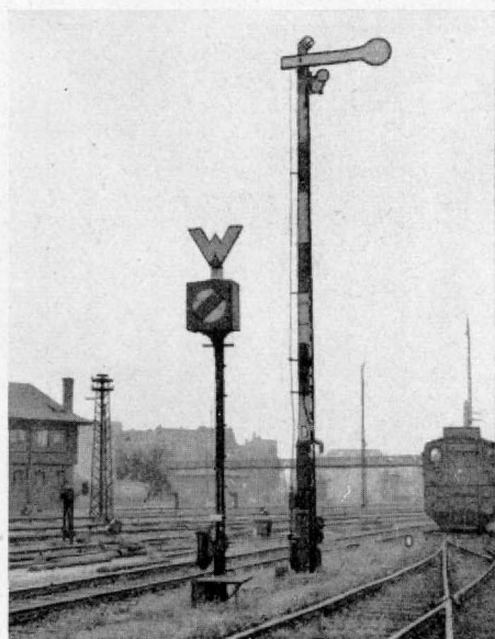
Abb. 2: Einflügeliges Hauptsignal und Gleissperrsignal mit Wartzeichen.
